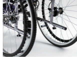
延長ティッピングバー(1ヶ) MS-0036 ¥3,300 部品価格オープン価格 ティッピングを延長する事により踏みやすくなります。段差越えなどキャスト（前輪）を上げる頻度の高い方に有効です。（ティッピングパイプ径φ17.5）
