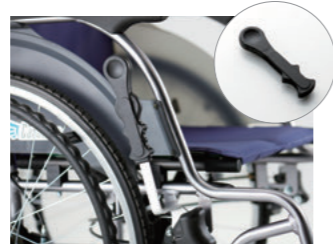
スライドブレーキ用延長レバー(1ヶ) MP60916-00-00 ¥1,750 部品価格オープン価格 スライド延長ブレーキを更に60mm延長できます。既存のカバーを外して取り付けるだけ。特別な工具は必要ありません。
